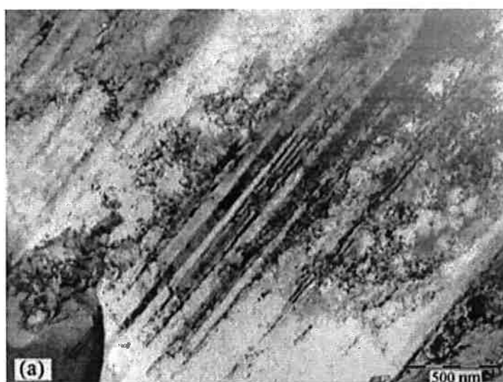
Figura 08: Maclas de deformação em um aço TWIP (25% Mn e 3% Al) deformado a - 80 °C
